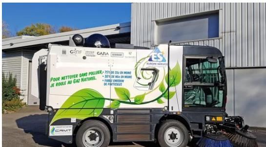
La CleaNGo CNG présente l'avantage de combiner des dimensions très compactes tout en disposant d'une capacité en déchets de plus de 5 m<sup>3</sup>.
